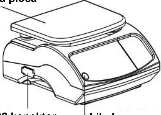
**RS-232 konektor****Libela****Ležište baterije**
